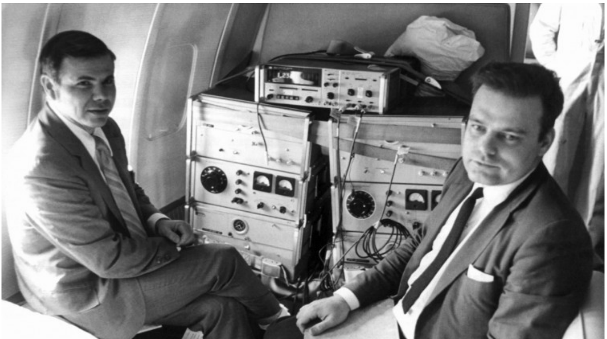
Experimento de Hafele y Keating (1971). 4 relojes atómicos de cesio en líneas aéreas alrededor del mundo.
